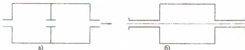
Рис. 2 - Схема двухкамерного (а) и однокамерного (б) реактивных глушителей
